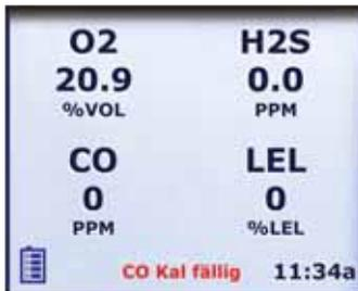
Eine Warnmeldung „Kalibrierung fällig“ wird für jeden relevanten Sensor angezeigt.
