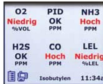
Alarmer werden mit dem Text „Go/No Go“ und blinkender Hintergrundbeleuchtung angezeigt.
